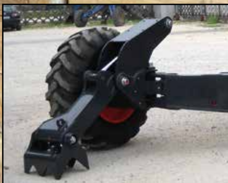
2 piedi articolati sulle ruote anteriori 2 jointed feet on the front legs 2 pi ds articul s sur le pattes avantes
