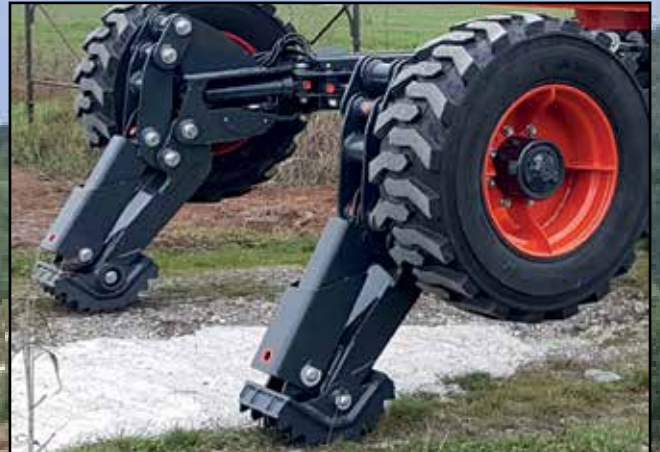
2 piedi articolati sulle ruote anteriori 2 jointed feet on the front legs 2 pieds articulés sur les pattes avant 2 große Gelenkfüße auf vorderrädern
