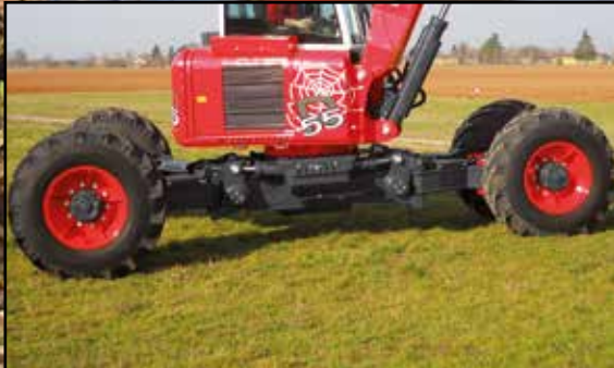
4 ruote sterzanti indipendenti 4 steering and independing wheels 4 roues directrices indépendents 4 selbständigen Lenkrädern
