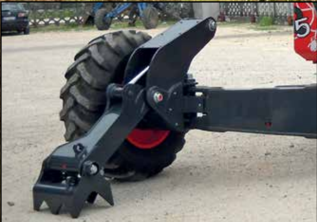
2 piedi articolati sulle ruote anteriori 2 jointed feet on the front legs 2 piéds articulés sur les pattes avantes 2 gróÙe GelenkfüÙe auf vorderrádem
