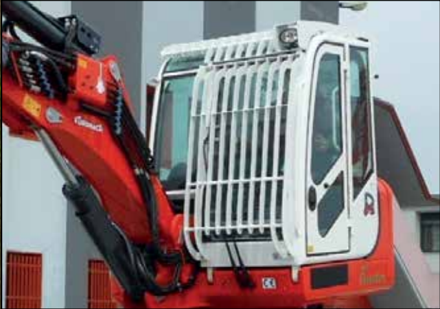
Griglia di protezione per cabine Protection of the cabin Grille de protection cabine Schutzgitter der Kabine
