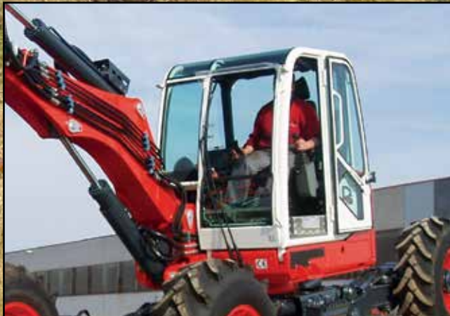
Vetri anteriori in Lexan Front glasses in Lexan Vitres avantes en Lexan Vorderscheiben in Lexan
