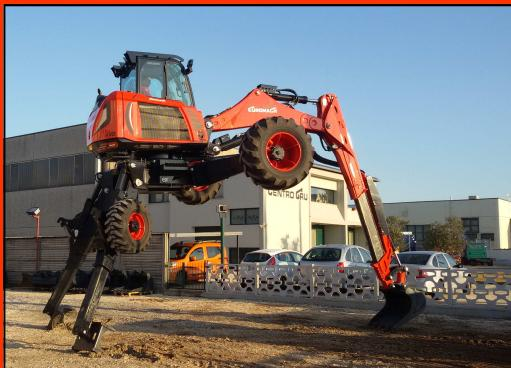
Il nuovo escavatore Euromach R953 monta un motore Kubota da 115 HP omologato Stage IIIB con filtro antiparticoloato incluso; una nuova cabina con migliore visibilità, ergonomia, design e nuovi cofani che ne migliorano l'estetica. L'impianto idraulico per la traslazione ha una pompa idrostatica Rexroth e il distributore del braccio è di tipo Load Sensing. L'impianto idraulico è composto da n. 5 pompe.
