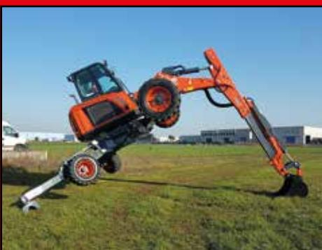
**Il nuovo escavatore Euromach R553 monta un motore Kubota da 75,3 HP omologato Stage IIIB con filtro antiparticolo incluso; una nuova cabina con migliore visibilità, ergonomia, design e nuovi cofani che ne migliorano l'estetica. L'impianto idraulico per la traslazione ha una pompa idrostatica Rexroth e il distributore del braccio è di tipo Load Sensing. L'impianto idraulico è composto da n. 3 pompe.**
